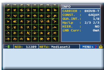
Fig. 4: CONSTELLATION DVB-T-64Q: Le tableau à droite donne tous les paramètres de réception en modulation.
