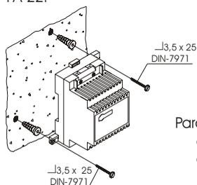
Instale el transformador en un lugar seco y protegido. Recuerde que la normativa vigente obliga a proteger el alimentador con un interruptor magnetotérmico.
