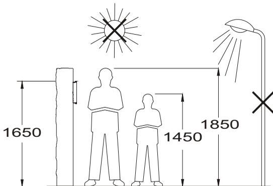
Placer la partie supérieure de la plaque à une hauteur approximative de 1.65m.
