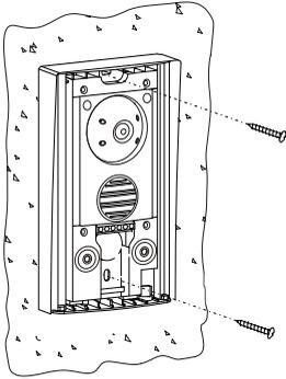
Installer le plaque de rue directement sur un mur, en plaçant la partie supérieure de la plaque a une hauteur approximative de 1.65m. et passer les câbles d'installation par l'entrée de câbles.
