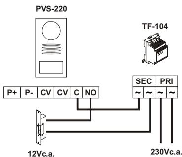
En cas de tension supérieure à 12Vc.c./ 1A entre les bornes C et NO de la plaque, utiliser un relais.
