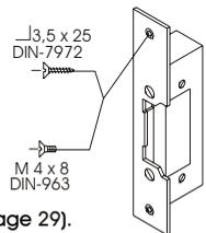
**IMPORTANT:** La gâche électrique doit fonctionner en 12V courant continu, (cf. page 29).
