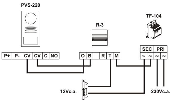
Conexión de un dispositivo auxiliar.
