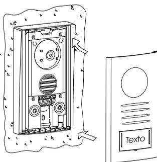
Con la ayuda de un destornillador, fíjelo mediante los tornillos situados en la parte inferior de la placa
