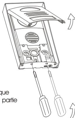
Avec l'aide d'un tournevis plat, retirer la partie frontale métallique effectuant une légère pression dans les orifices situés dans la partie inférieure de la plaque, comme indiqué sur le dessin.
