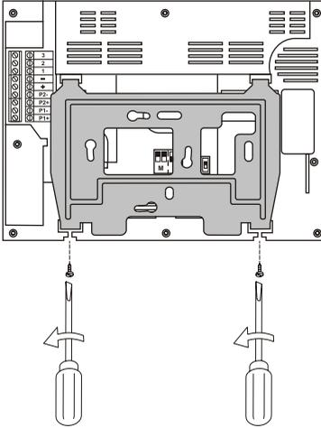
Quite los tornillos situados en la parte inferior de la placa para liberar el soporte de fijación.
