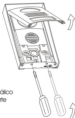
Con la ayuda de un destornillador plano, retire el frontal metálico haciendo una ligera presión en los orificios situados en la parte inferior de la placa, tal como se muestra en el dibujo.
