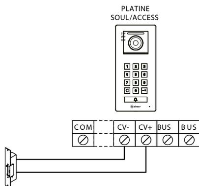
Si vous souhaitez installer une gâche électrique en courant alternatif, veuillez employer un relais et un transformateur adapté à la consommation, et la varistance fournie. L'exemple illustre un relais UTRL12 et un transformateur GTF-104 (12 Vca / 1,5 A).
