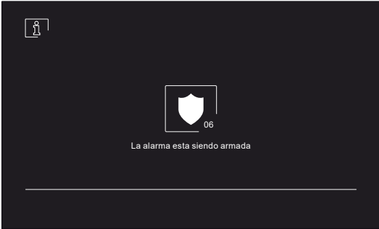
Armado de la alarma. Tras finalizar la cuenta atrás. Nos confirmara el armado en pantalla, indicando “la alarma ha sido armada”.
