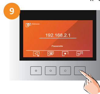
Saisir l'adresse de la passerelle puis valider
