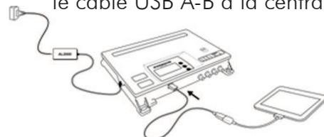
5. La tablette reconnaît automatiquement la version de la centrale connectée au port USB et l'application «ALBPROGMOBILE» est lancée automatiquement.
