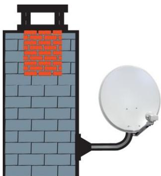
Bras de déport pour paraboles. Choisir le déport et le diamètre du mât en fonction du diamètre de l'antenne et de la direction du satellite à pointer.
