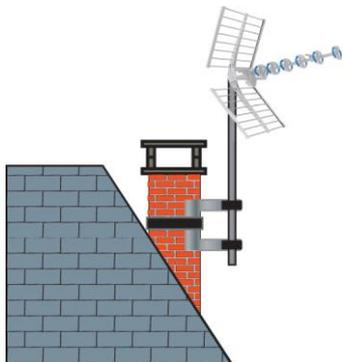
Fixation de cheminée simple avec étriers pour mâts de 30 à 50 mm avec 1 feuillard en acier galvanisé.
