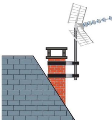
Fixation de cheminée double avec étriers pour mâts de 30 à 50 mm avec 1 feuillard en acier galvanisé.
