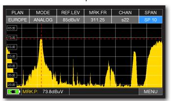
CATV spectrum SPAN "10 MHz".
