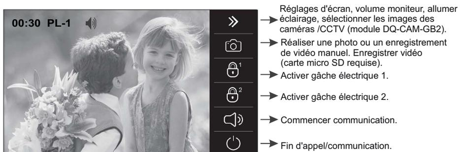
Si vous souhaitez ouvrir la porte 1, pressez l'option de gâche électrique au cours du processus d'appel ou de communication : une seule pression active la gâche électrique pendant 5 secondes.
