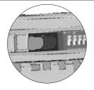
\* En cas de croisement, si celui-ci est éliminé dans les 2 minutes suivantes (environ), le convertisseur se réarmera automatiquement, une fois ce temps passé, il sera nécessaire de réarmer le convertisseur à travers du micro-interrupteur n°.3 (cf page 21). escription des leds d'autodiagnostic.
