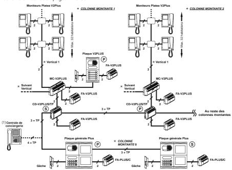
Codificateur de colonne montante (Plaque codifiée). Cette variante permet d'installer plaques à défilement de noms *Plus* avec moniteurs/postes d'appel *V2Plus*, le convertisseur sera connecté à la sortie de la plaque. Optionnellement peut intercaler une centrale de conciergerie *CE-990 Plus* entre le convertisseur et la plaque à défilement de
