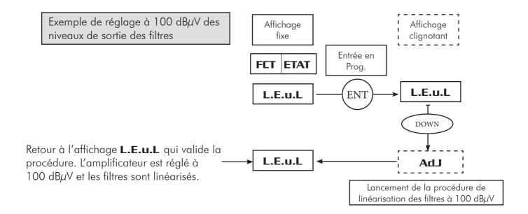
Dans le cas où le niveau d'entrée est insuffisant pour atteindre le niveau de sortie souhaité (100 dB $\mu$ V demandé en sortie mais 55 dB en entrée), le gain maximum de la centrale étant de 40 dB, le niveau de 100 dB $\mu$ V ne pourra être atteint (55 + 40 = 95), l'afficheur vous indiquera **F1Lo** qui veut dire que le niveau du filtre N°1 est insuffisant. Pour continuer la procédure , appuyer sur **ENT**. Pour continuer la procédure , appuyer sur **ENT** jusqu'à **L.E.u.L.**
